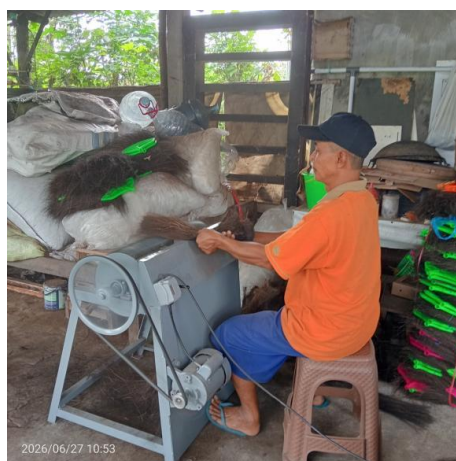
Gambar 4. Pemilik Usaha Mengoperasikan Mesin Penyisir dan Perapih Serat Secara Mandiri.
